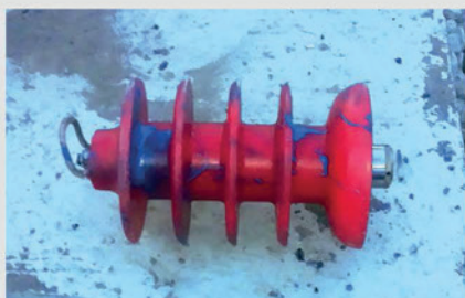
Поршень полиуретановый Семигор-4Д1М-С42-159 с установленным передатчиком Семигор-С-42-Б.
