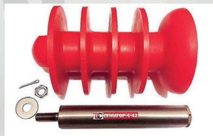
Поршень Семигор-4Д1М-159 (код 57-057) в новом исполнении с передатчиком Семигор-С-42-Б (код 4Б4-16) с более коротким болтом, для прохождения поворотов трубопровода 159 мм радиусом 1,5DN.
