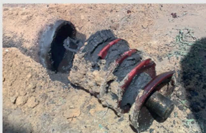
Поршень извлечен из трубопровода.
