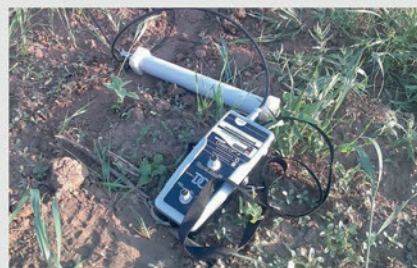
Поршень не прошел контрольный пункт в расчетное время, поднялось давление на пуске. Первая бригада сопровождения осталась на контрольном пункте ждать поршень. Вторая бригада произвела поиск места остановки поршня в течении одного часа. Место остановки поршня.
