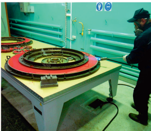
Обработка полиуретана пламенем.
