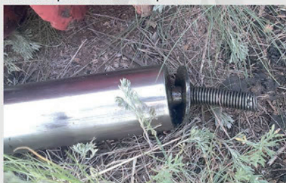
Деформация болта передатчика при прохождении поршнем поворотов радиусом 1,5DN. Для этого был разработан комплекс: - цельнолитой поршень в новом исполнении; - передатчиком Семигор-С-42-Б (код 4Б4-16) с более коротким болтом М16
