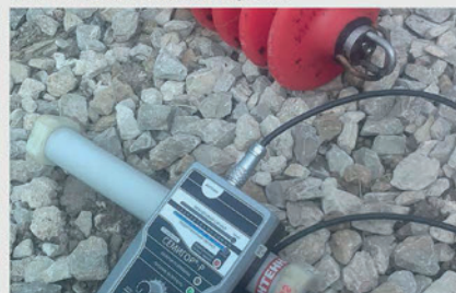
На следующий день, запуск второго поршня по данному трубопроводу. Проверка работоспособности передатчика.
