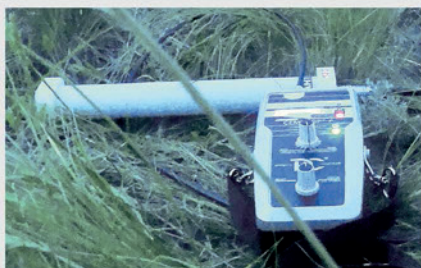
Проверка работоспособности передатчика приемником Семигор®-Р.
